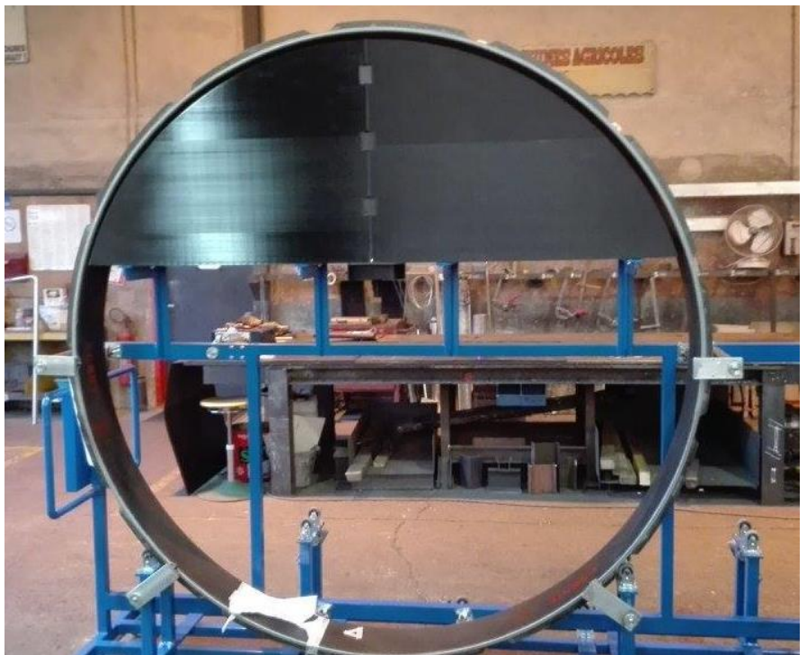
Outillage d'aspiration hybride (Impression XXL)
