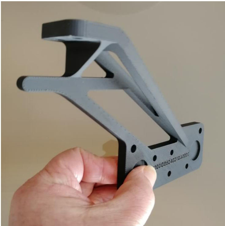
Grille de perçage avant contrôle tridi et montage
