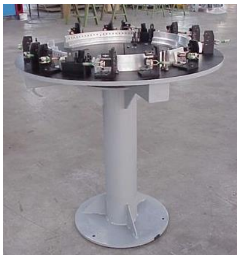
Ouillage de perçage
