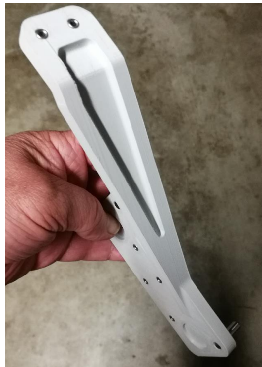
Grille de perçage montée et contrôlée
